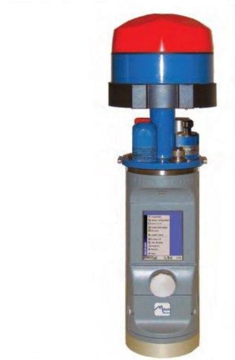
Рисунок2.2 Внешний вид измерительного комплекса AANDERAA RDСP-600
