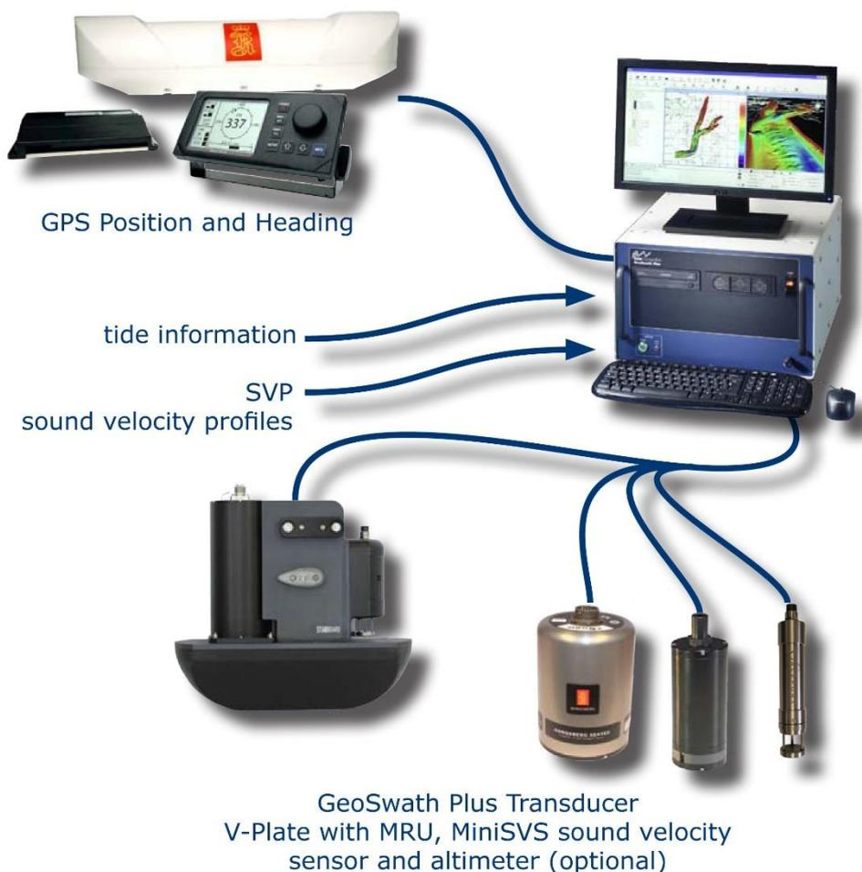
Рисунок 2.2.2.5 – Состав оборудования KongsbergGeoSwathPlus.
