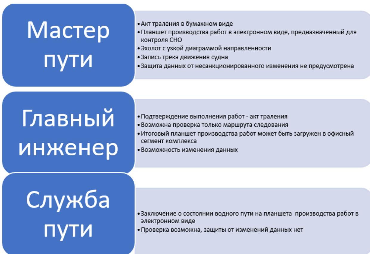
Рисунок 2.1.1.7 – Распределение потоков данных при проведении траления с использованием АОК.
