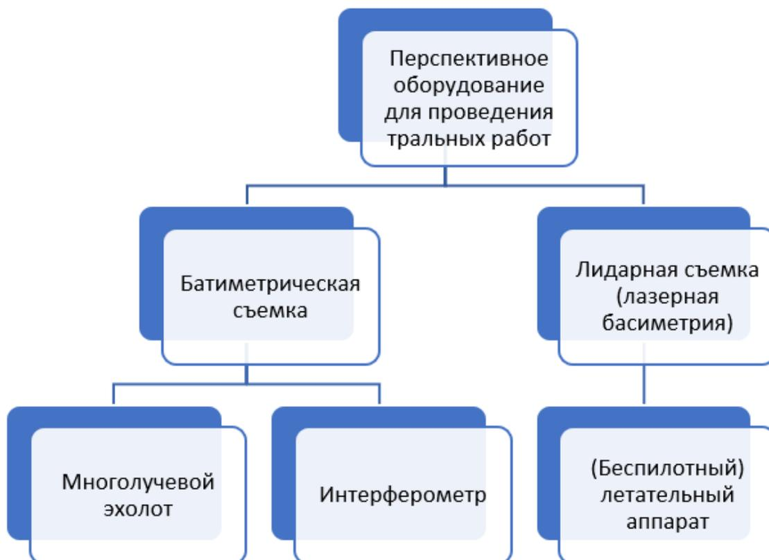
Рисунок 2.2.2.1 – Перспективное навигационное оборудование для проведения тральных работ.
