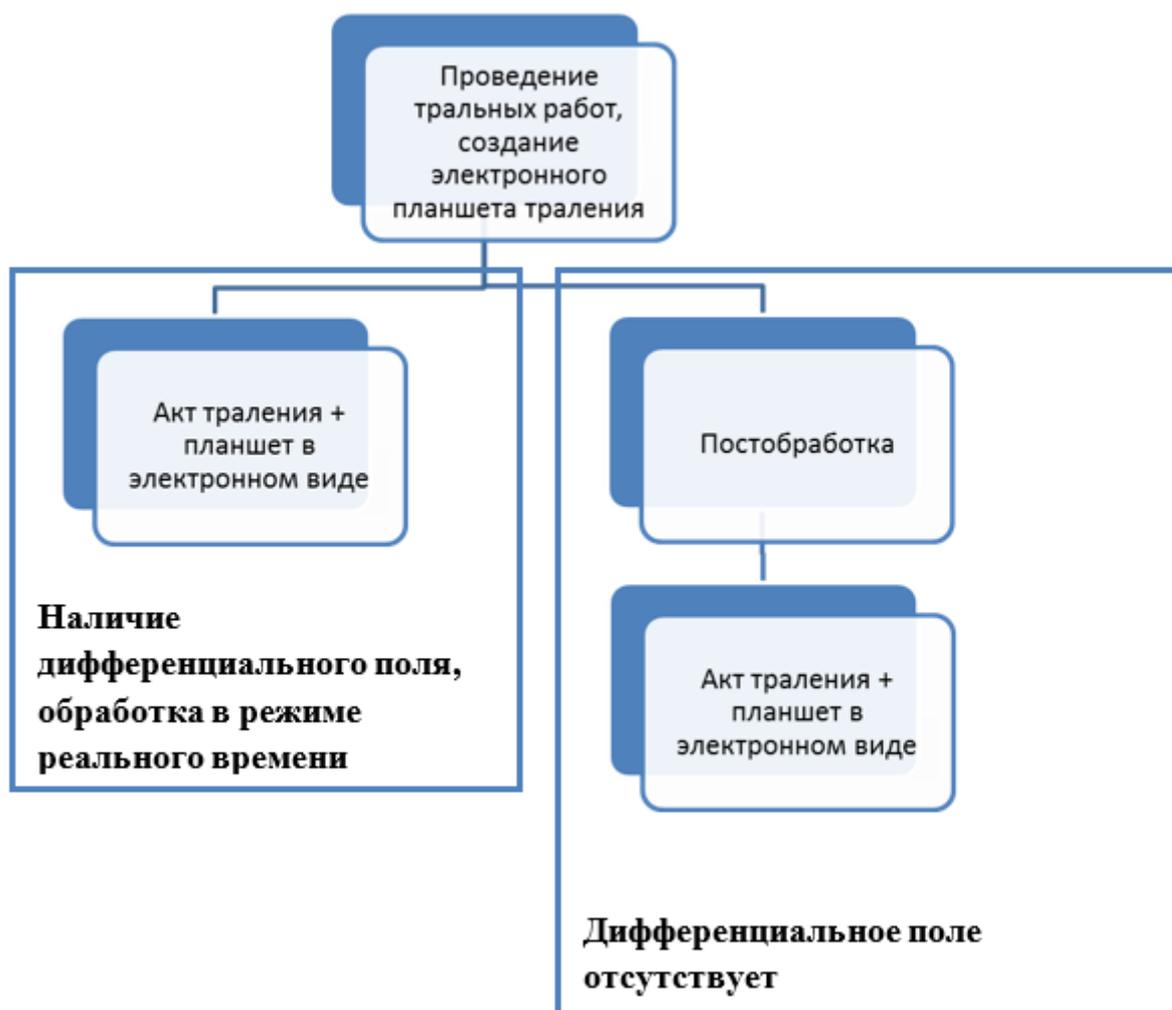
Рисунок 2.2.1.2 – Отчетные материалы, получаемые в результате работы перспективного АТК на разных типах ВВП РФ.
