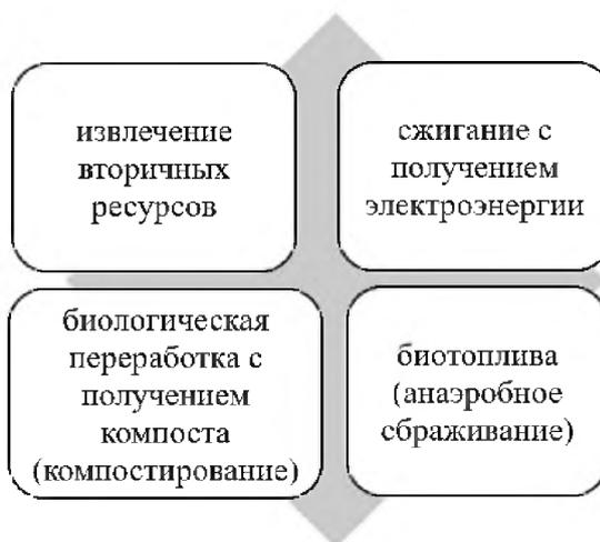
Рисунок 1.6 – Способы обезвреживания, переработки и утилизации твердых коммунальных отходов
