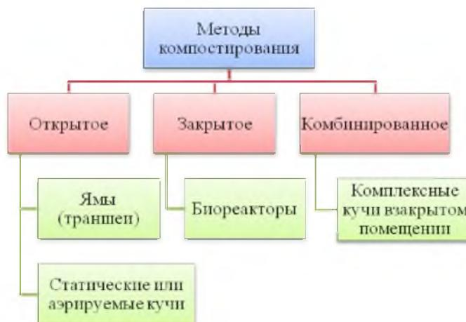
Рисунок 1.10 – Методы компостирования
