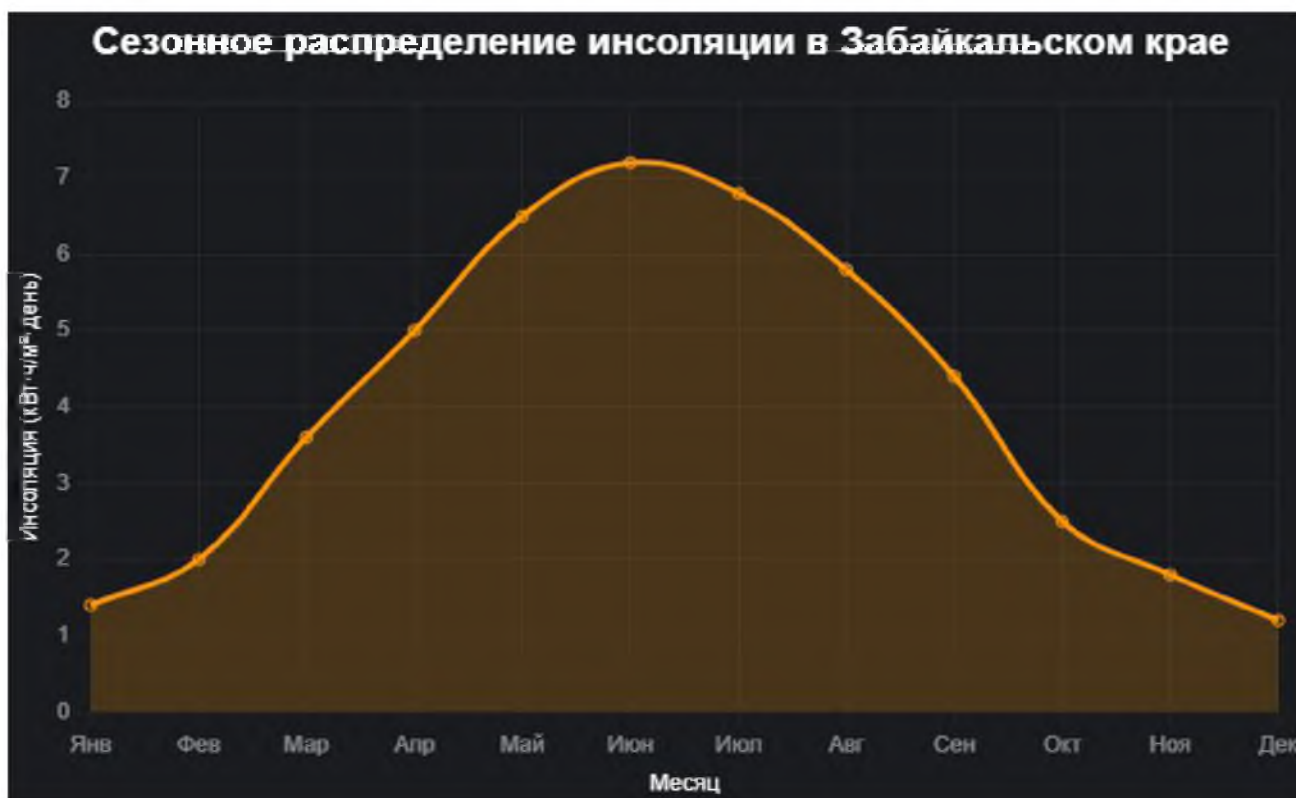
Рисунок 2.8 – Сезонное распределение инсоляции в Забайкальском крае
