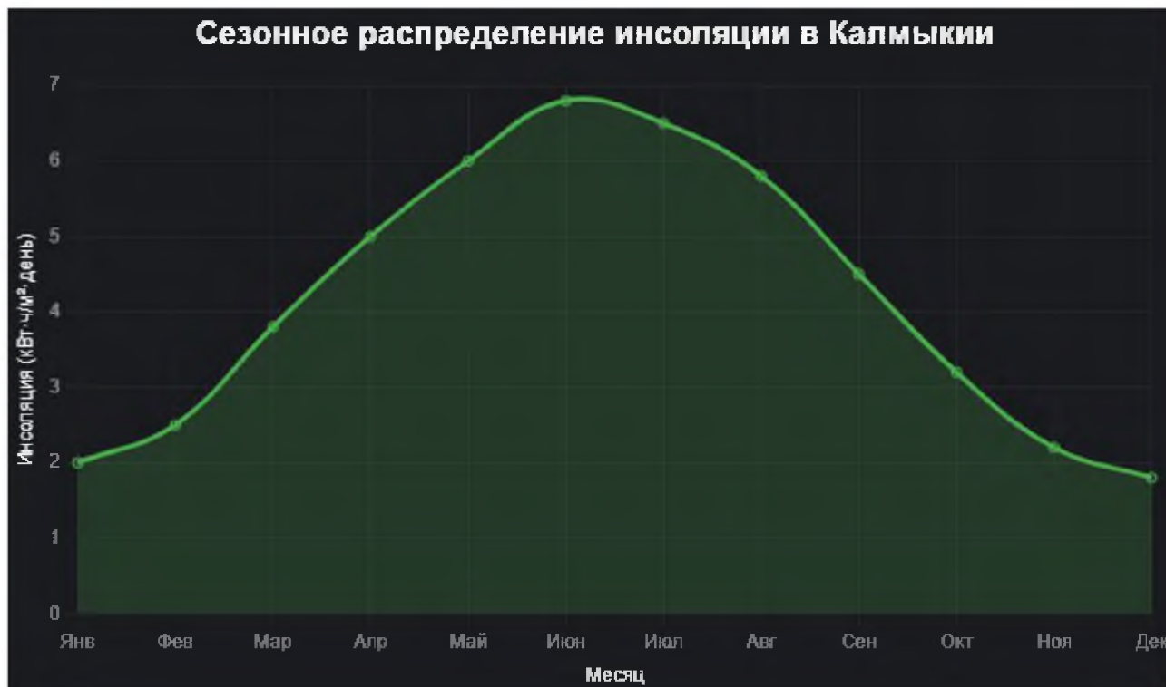
Рисунок 2.3 – Сезонное распределение инсоляции в Калмыкии
