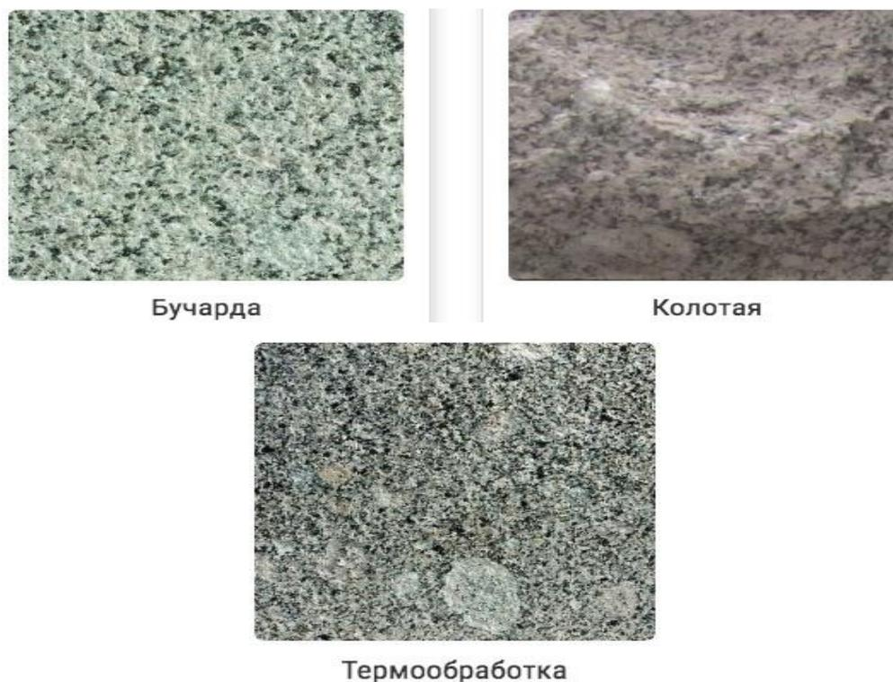
Рисунок 6 –Различные варианты обработки гранитных блоков, реализуемых предприятием ОАО «Возрождение»
