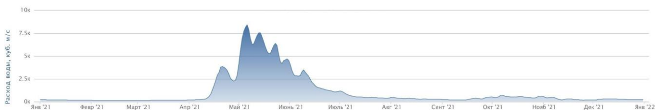
Рисунок 1.3 – Характерный гидрограф расходов воды на гидрологическом посту р. Томь – г. Томск за 2021 год
