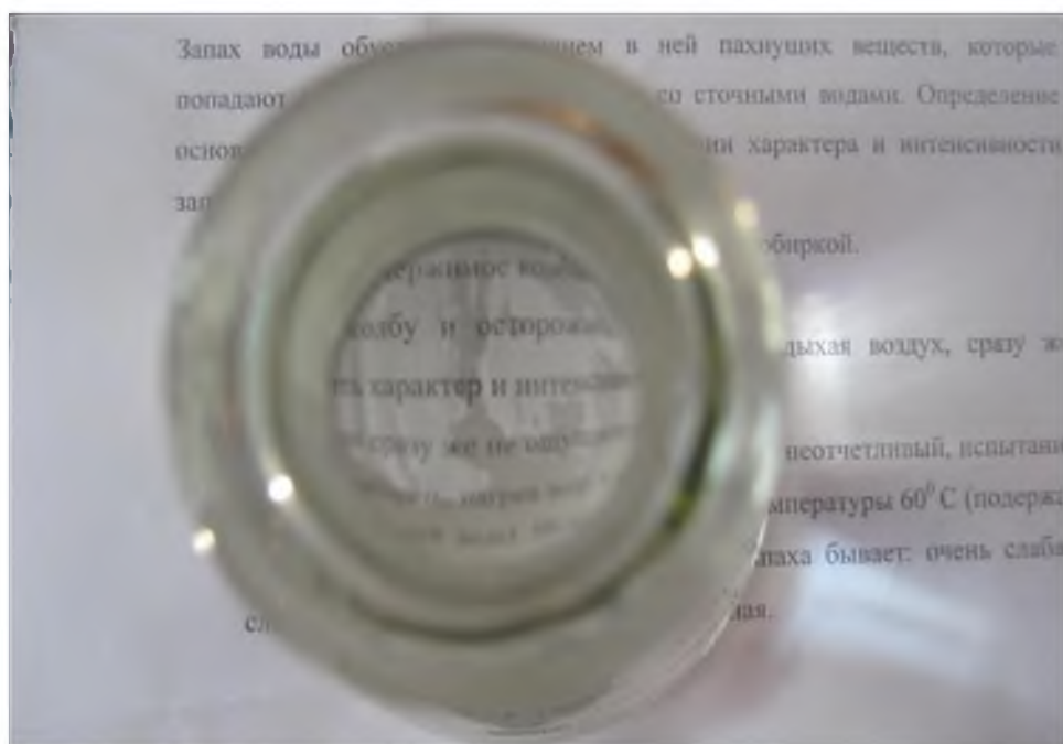
Рисунок 16 – Определение прозрачности по методу шрифта
