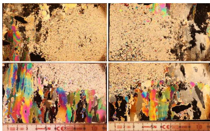
Рисунок 62 – Структура зоны разрушения перпендикулярно направлению внедрения индентора, 21.07.2023. Горизонт 30 см, диаметр индентора 90 мм
