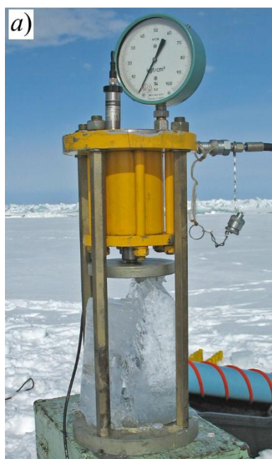
Рисунок 21 – Испытание на одноосное сжатие.
