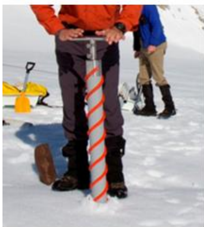
Рисунок 19 – Пример подготовка образцов льда в виде цилиндров из блока льда.
