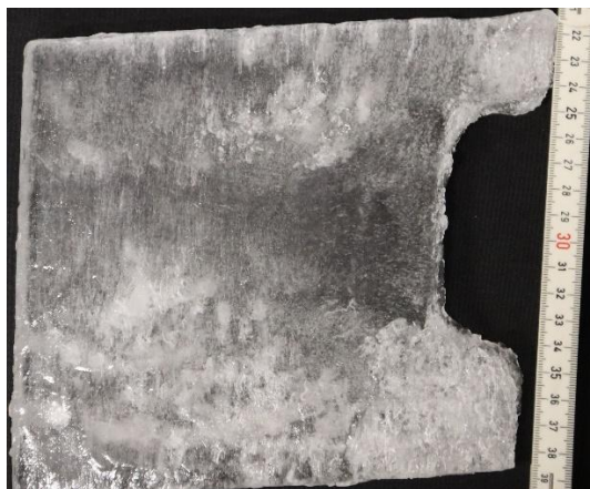
Горизонт 30 см, диаметр индентора 90 мм
