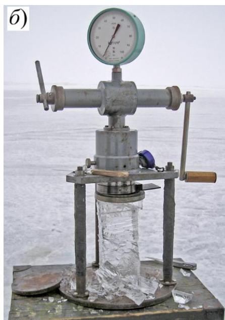
Рисунок 21 – Испытание на одноосное сжатие.
