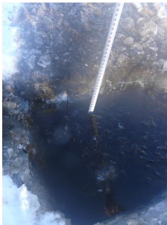
Рисунок 5.3 – Измерение глубины потока и толщины льда на водотоке № 1 (фото октября 2013 г.)
