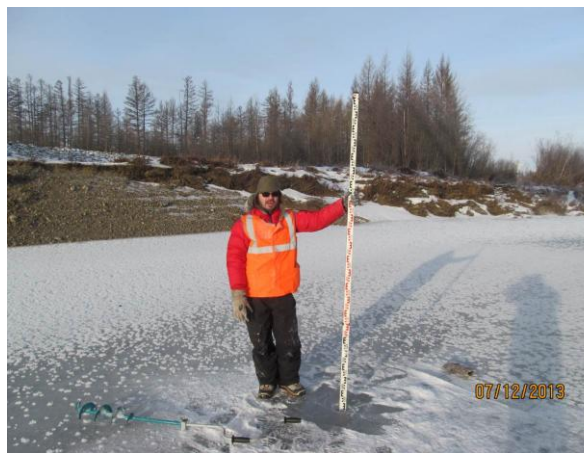
Рисунок 5.13 - Промеры глубин со льда на р. Чара
