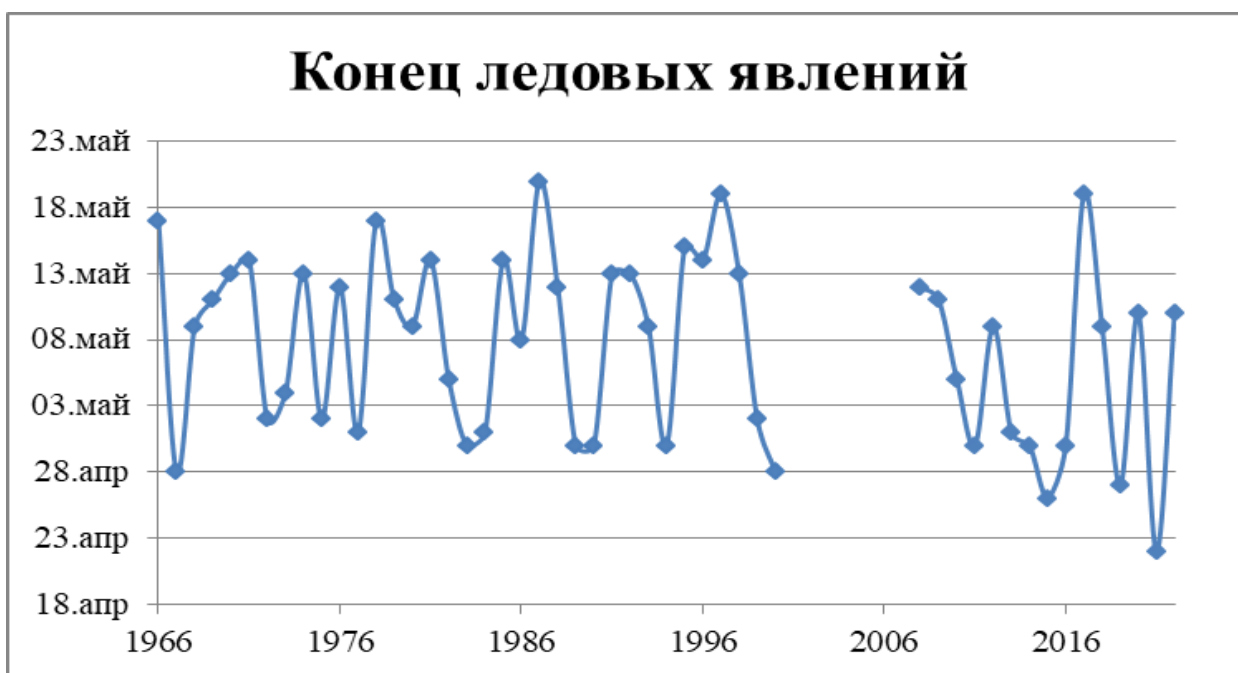
Рисунок 3.6 – График хода дат конца ледовых явлений р. Чирка-Кемь – с. Юшкозеро
