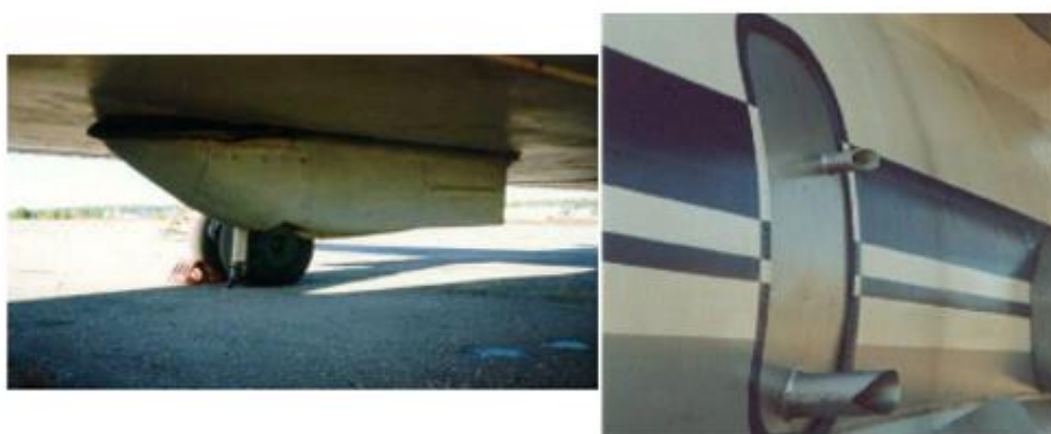
Рисунок 7. Устройства для выброса твердой углекислоты с самолета Ан-30
