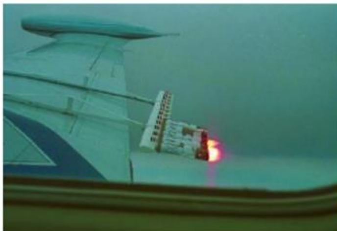
Рисунок 11. Самолетные пиротехнические аэрозольные генераторы, установленные на крыле самолета
