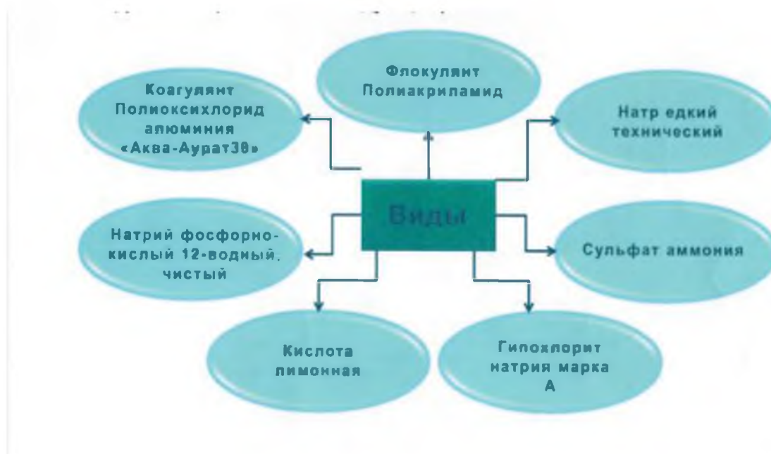
Рисунок 12 – Виды реагентов, используемых на очистных сооружениях [22, с.75]
