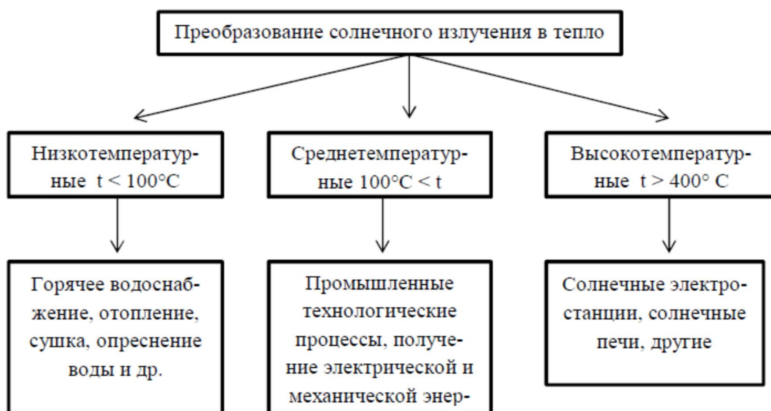
Рисунок 1.2 - Преобразование солнечного излучения в тепло
