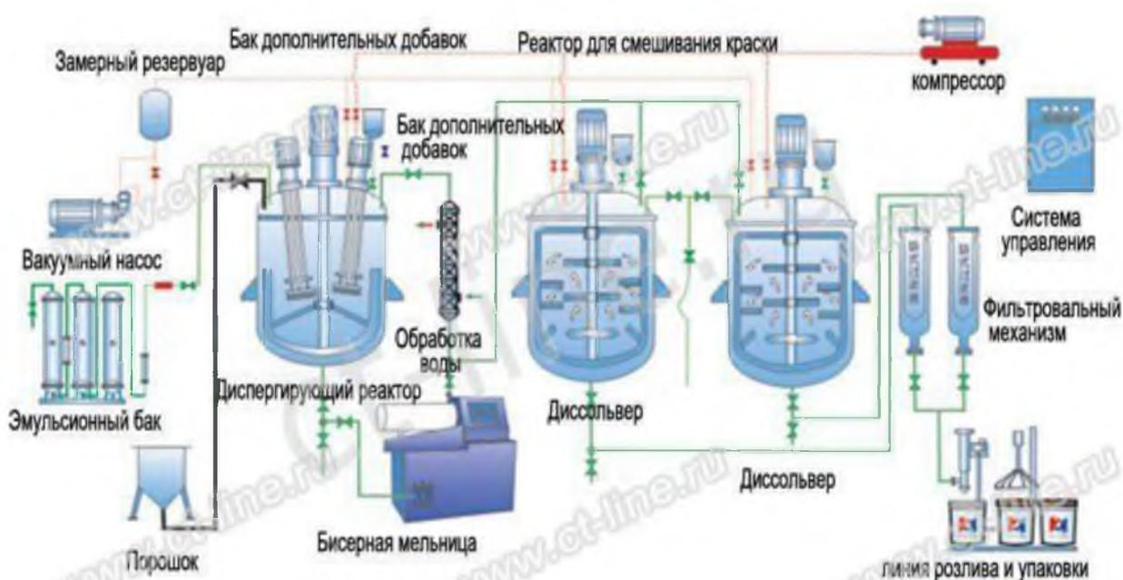
Рисунок 1 – Технологическая схема производства водоэмульсионной краски
