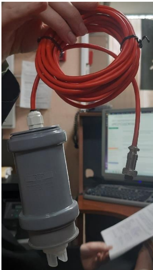
Рис. 2.11 Герметично закрытый датчик с подсоединением к кабелю.
