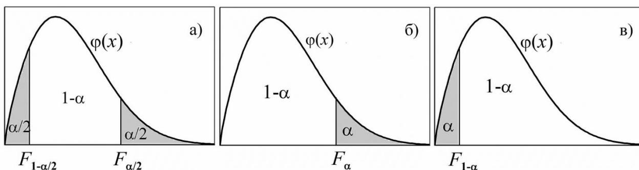
Рис. 2.6. Критические области для F-распределения (закрашены серым цветом), на горизонтальной оси отмечены соответствующие значения величины
