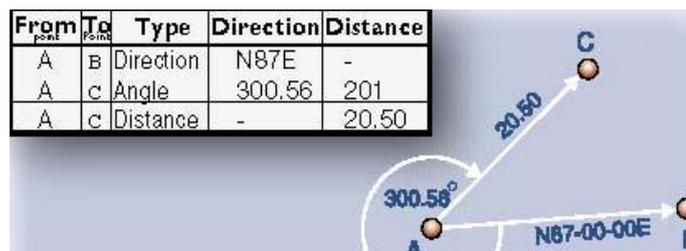
Рис. 3.5 Наборы данных геодезической съемки
