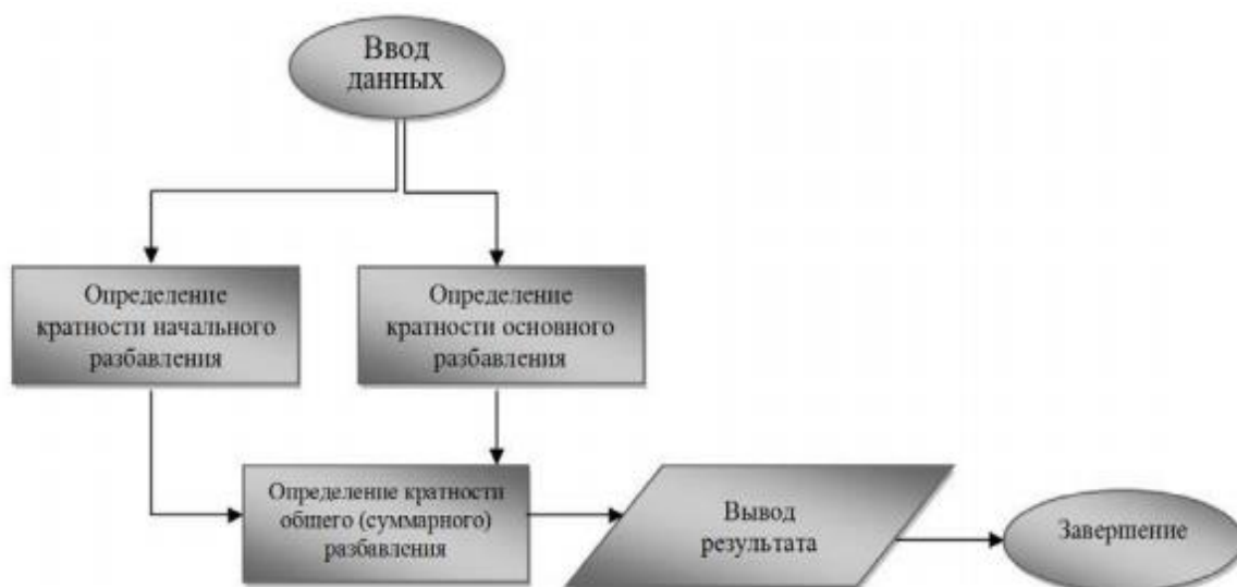
Рисунок 5 – Обобщенная блок-схема работы информационно-советующей системы расчета кратности разбавления сточных вод [7]
