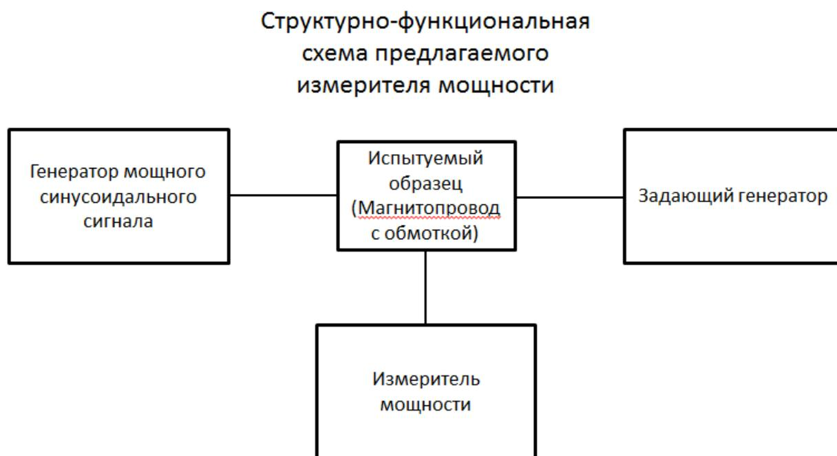
Рисунок 4 - Структурно-функциональная схема предлагаемого измерителя мощности
