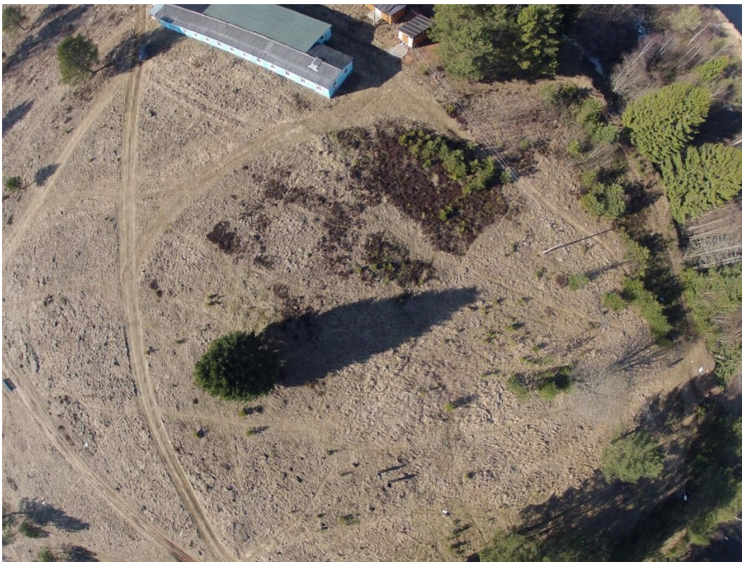
Рисунок 10 - Пример снимка с нелинейным искажением.
