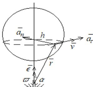
Из приведенного рисунка видно, что модуль скорости  $v = \omega h = \omega r \sin \alpha$  совпадает с модулем векторного произведения  $\vec{\omega} \times \vec{r}$ . Направление скорости тоже совпадает с направлением этого векторного произведения. Поэтому
