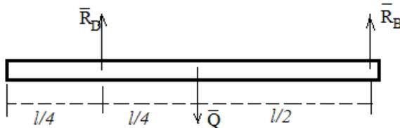
Следовательно, в данной задаче мы имеем дело с системой параллельных сил, изображенных на рисунке. Система уравнений равновесия состоит из двух уравнений: суммарная проекция всех сил на вертикальную ось равна нулю и суммарный момент относительно, например, точки  $D$ , тоже равен нулю. Таким образом, имеем равенства
