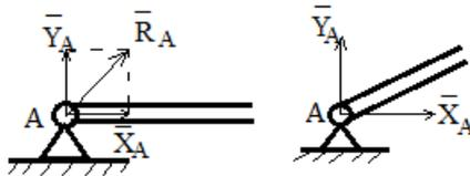
6. Шарнир на катках. Приведенный рисунок означает, что опора может двигаться влево и вправо. Так что ограничение остается только на перемещение вверх и вниз, соответствующим образом направлена и реакция опоры.
