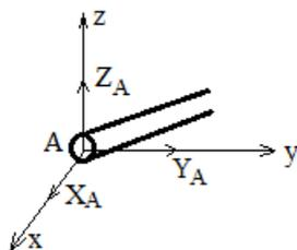
8. Жесткая заделка. Такое ограничение препятствует перемещению и повороту вокруг точки закрепления. Приходится вводить три неизвестных величины: две взаимно перпендикулярные составляющие и момент, препятствующий выкручиванию из заделки. Момент  $M_a$  называют *моментом заделки*.
