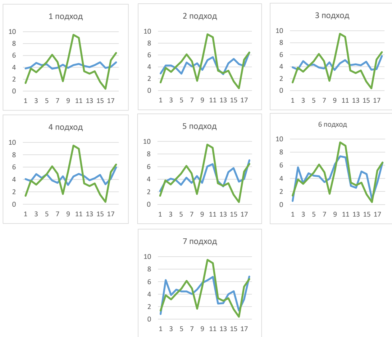
Рисунок 5 – Результаты прогнозов (по оси абсцисс – порядковый номер прогноза, по оси ординат – среднеемесячный расход воды за март; фактические значения отмечены зеленым цветом, спрогнозированные – синим)
