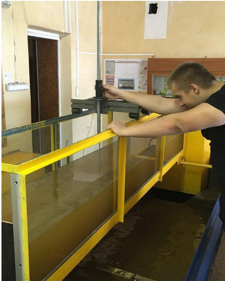
Рисунок 3.1 – Измерения уровня воды шпиценмасштабом
