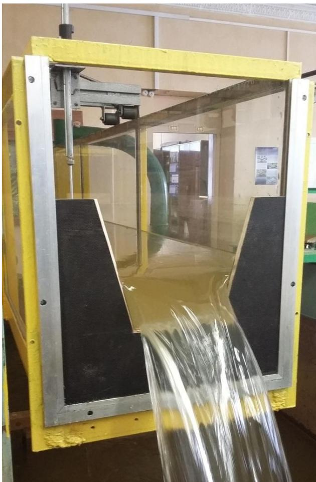
Рисунок 3.2 – Эксперименты с водосливом трапецеидального профиля
