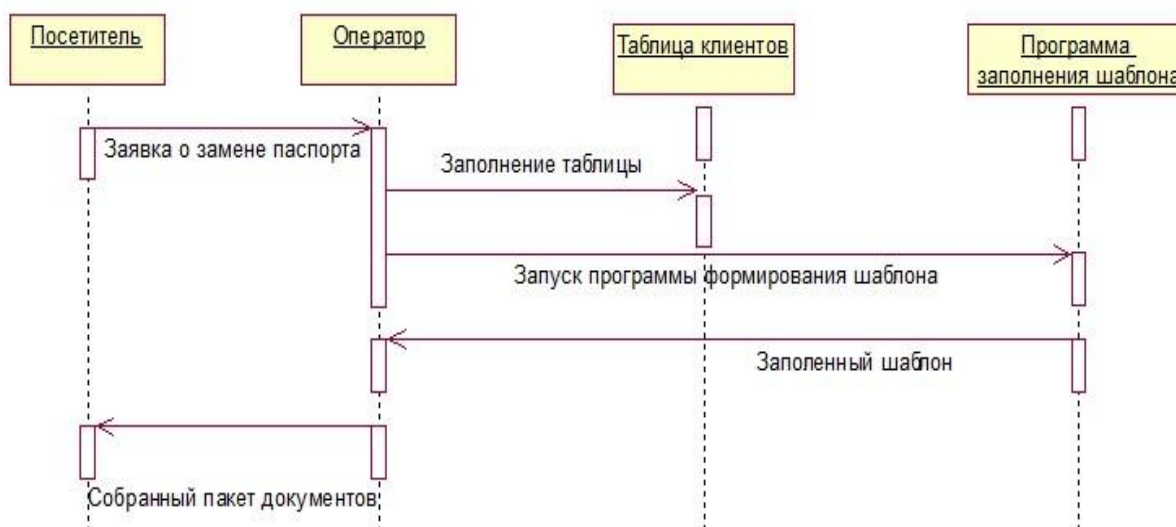
Рисунок 12 Диаграмма последовательности действий 12
