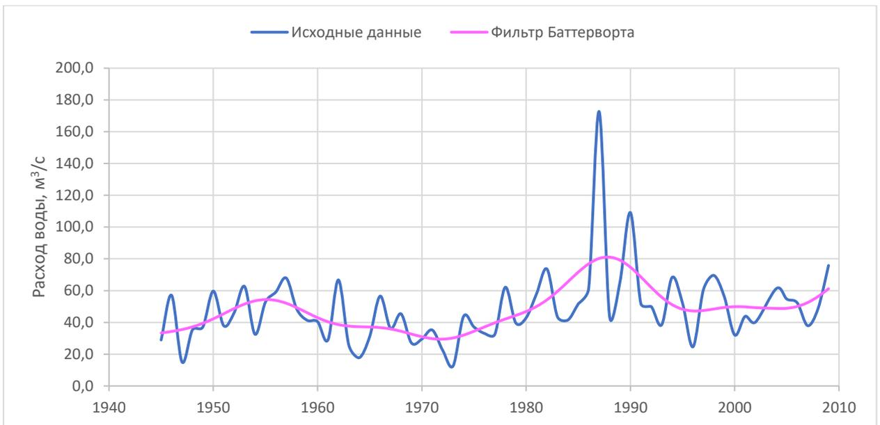
Рисунок 2.12 – Результаты низкочастотной фильтрации Баттерворта среднегодовых расходов воды р. Шелонь – д. Заполье
