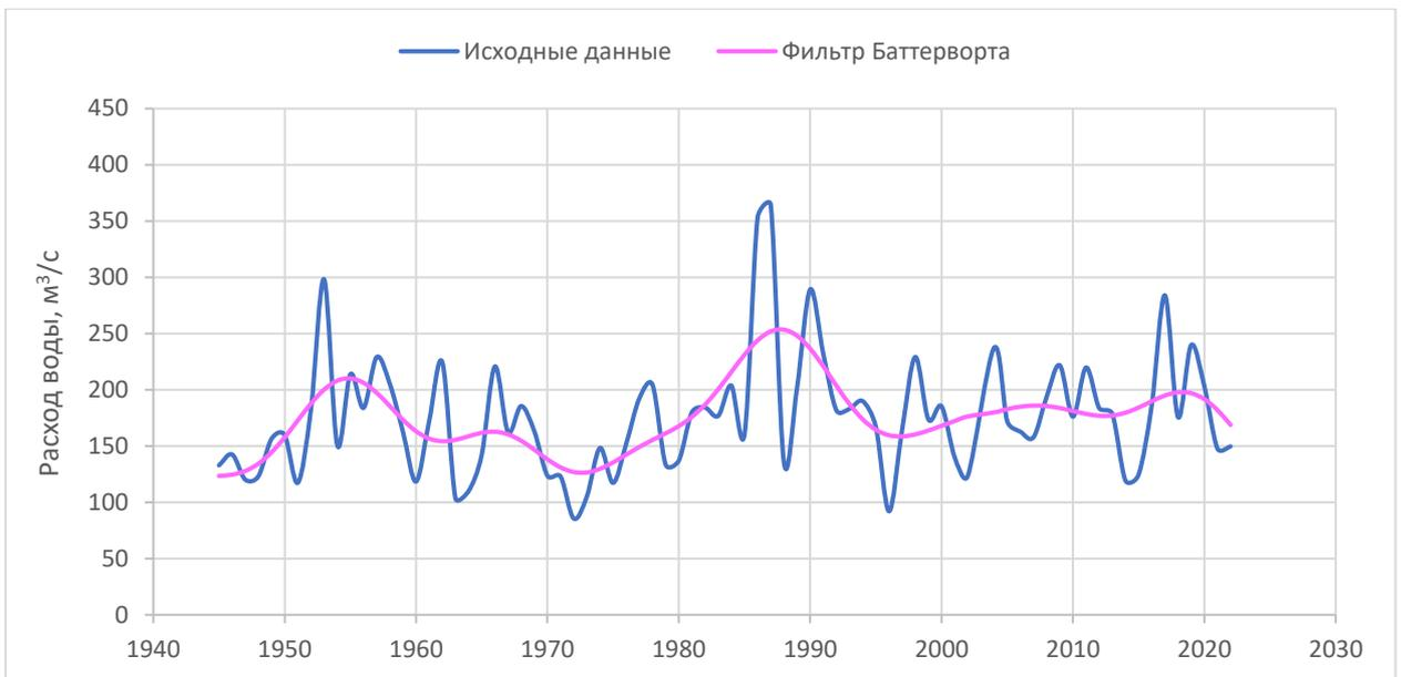
Рисунок 2.10 – Результаты низкочастотной фильтрации Баттерворта среднегодовых расходов воды р. Мста – д. Девкино
