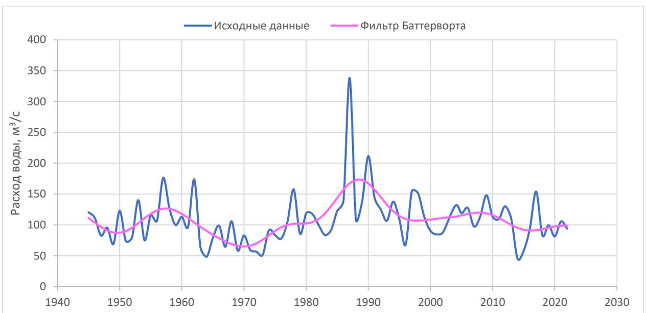
Рисунок 2.11 – Результаты низкочастотной фильтрации Баттерворта среднегодовых расходов воды р. Ловать – г. Холм
