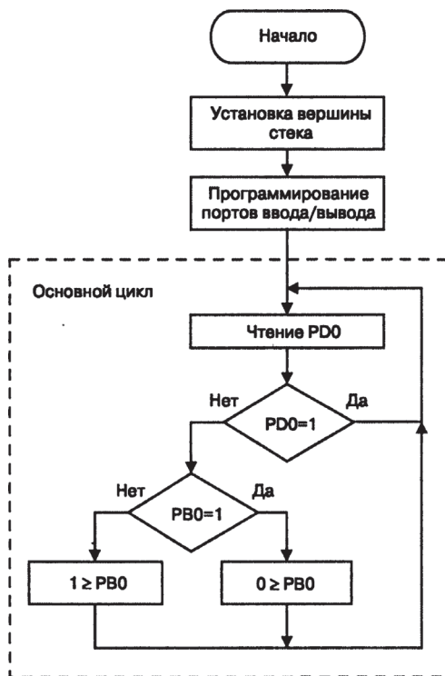
Рис. 3. Алгоритм программы для схема управления светодиодом
