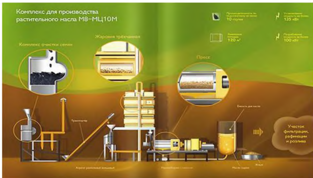
Рисунок 1.12 - Схема начальной переработки М8 - МЦ10М
