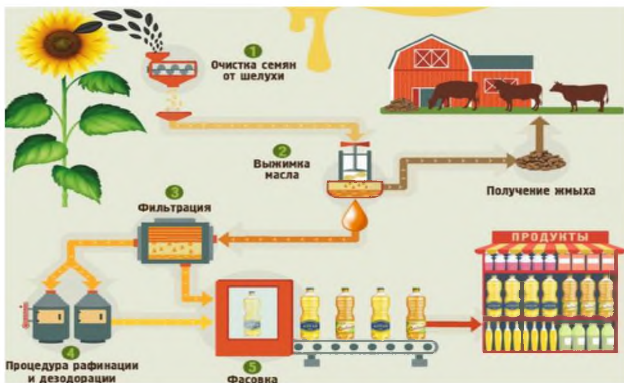
Рисунок 2.3 - Схема переработки подсолнечника на предприятии
