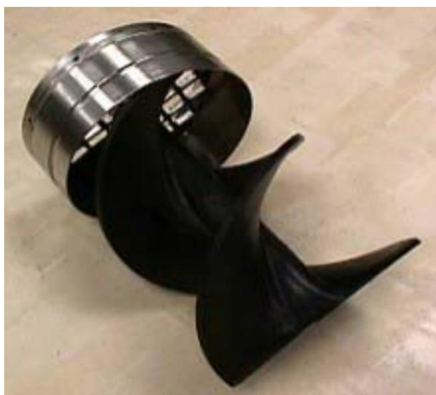
Рисунок 3.1 – Вращающийся световой отражатель [32]
