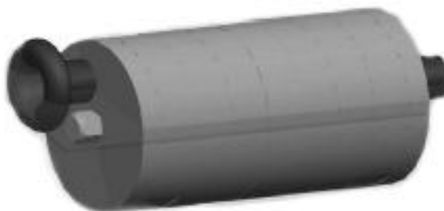
Рисунок 2.4 – Универсальный биолюминесцентный батифотометр (MBVP) [27]
