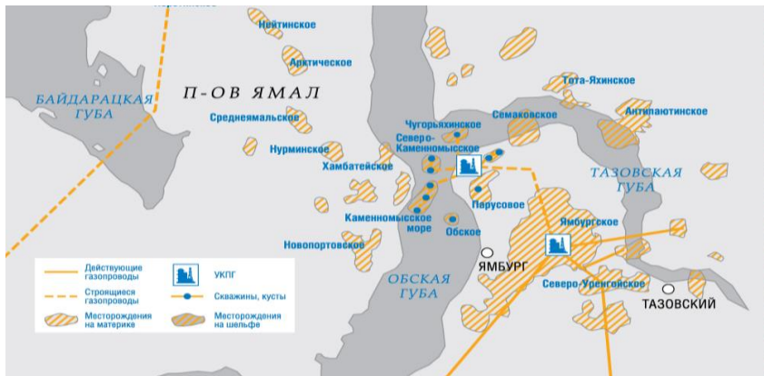
Рис. 3.4. Положение месторождений Каменномыское-море, Северо-Каменномыское и Чугурьяхинское относительно трубопроводной магистрали
