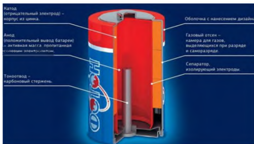
Рисунок 8 - Схема строения щелочной (алкалиновой) батарейки [11, с.34]
