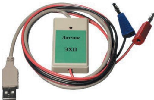
Рис. 20. Датчик электрохимического потенциала
