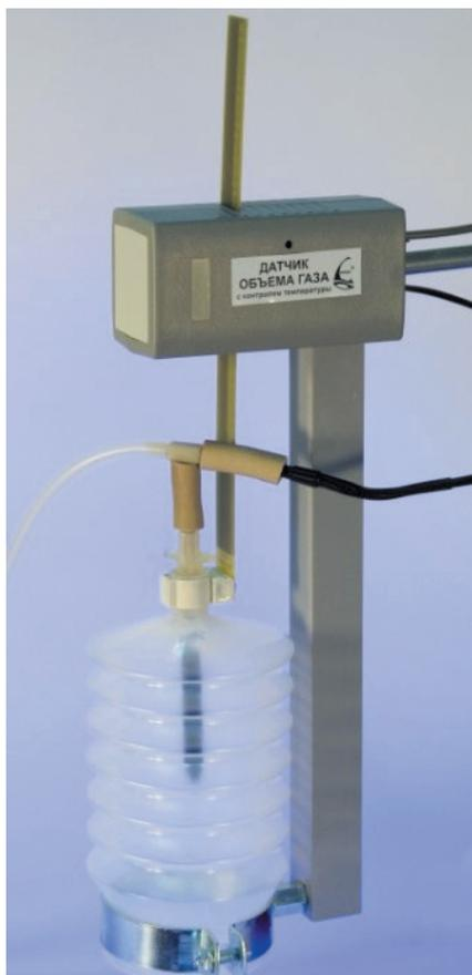
Рис. 18. Датчик объема газа с контролем температуры
