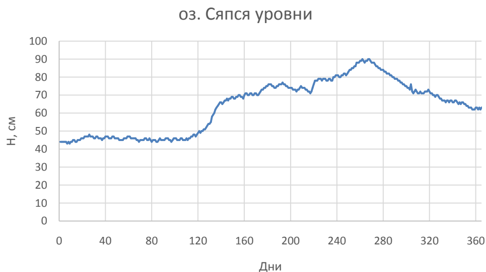
Рисунок 3.7 - Хронологический график хода уровней воды в озере 1967 год
