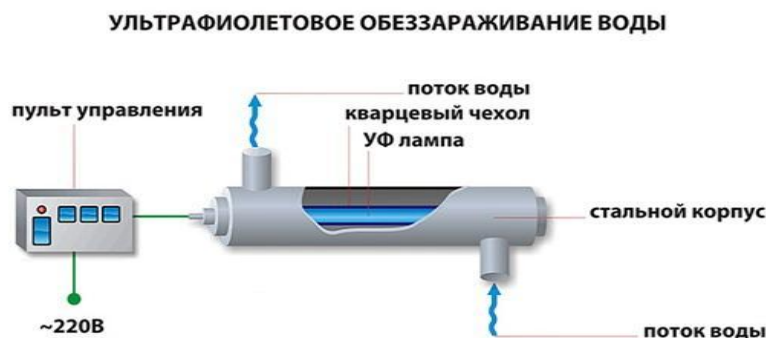
Рис. 3.3. Метод очистки воды путем УФ - установки [13,с.81]
