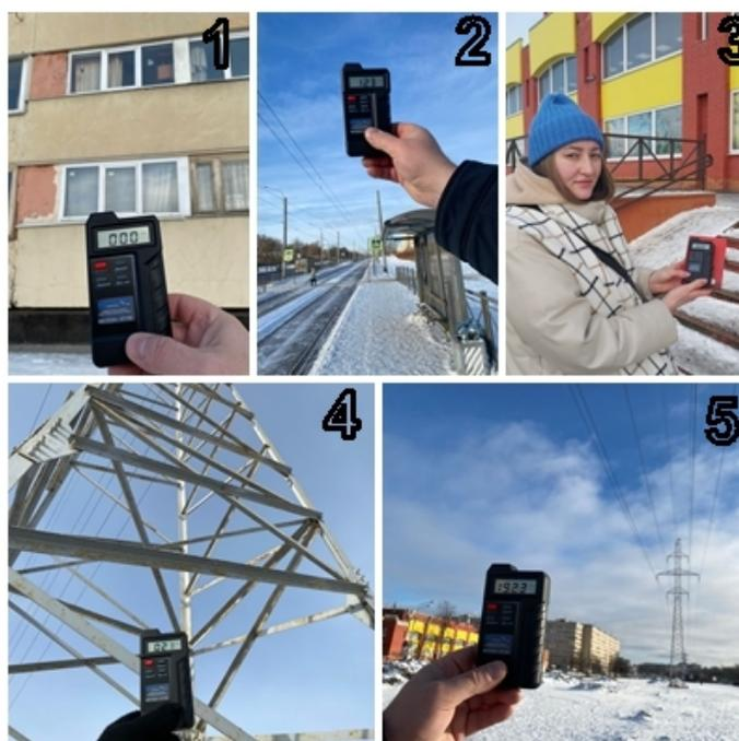
Рисунок 4.3 Измерение электромагнитного и магнитного поля: 1 – рядом с жилым домом Петергофское шоссе, д. 7; 2 – в районе трамвайной остановки (Петергофское шоссе, д. 5); 3 – у-м Пловдив, вход; 4 – под опорой ЛЭП; 5 – ЛЭП, от центра 20 м в сторону жилого дома, Петергофское шоссе д. 5.
