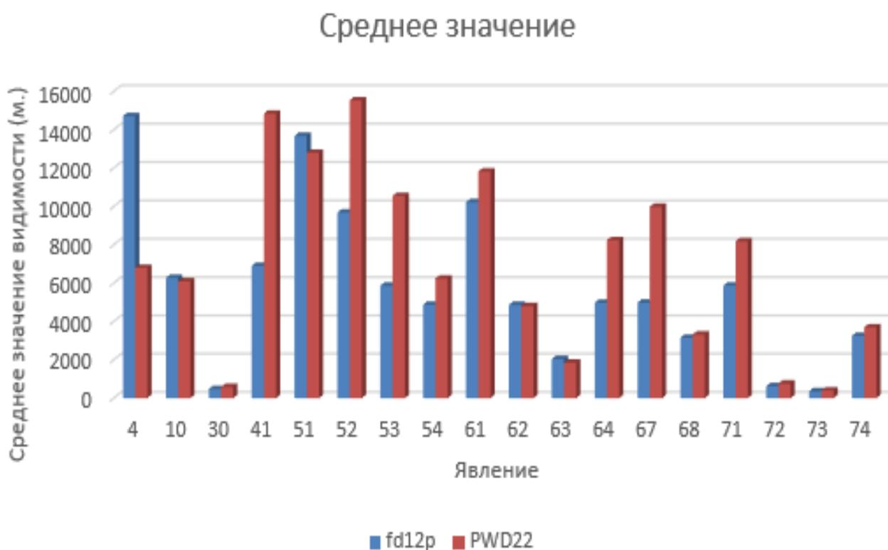
Рисунок 3.6 – Средние значения видимости и соответствующие ей явления погоды по датчикам fd12p и PWD 22
