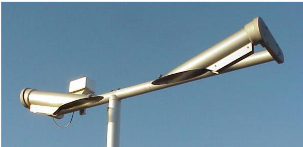
Рисунок 2.4 –Нефелометр FD12P
