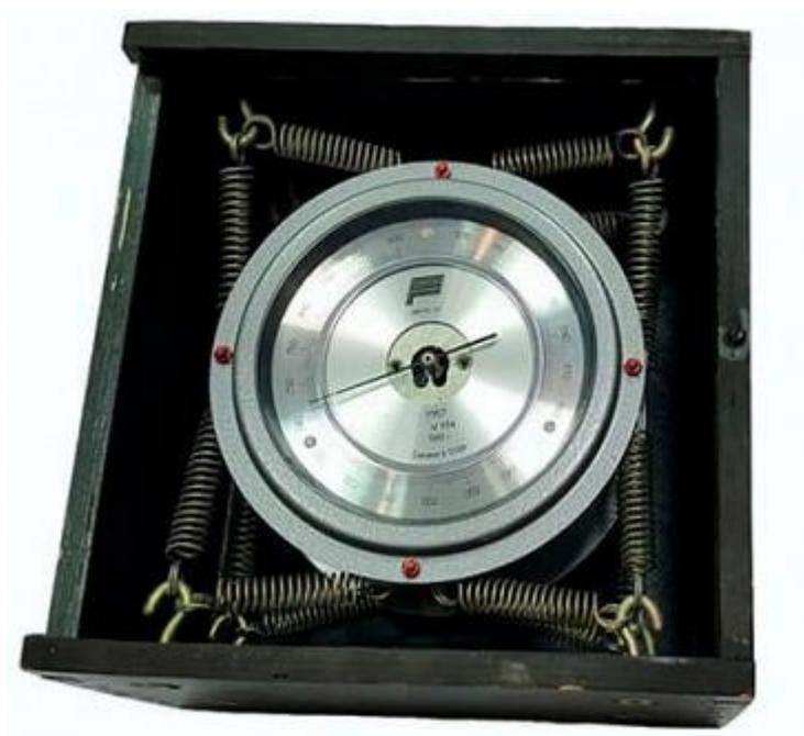
Рисунок 1.1 – Барометр anerоид
