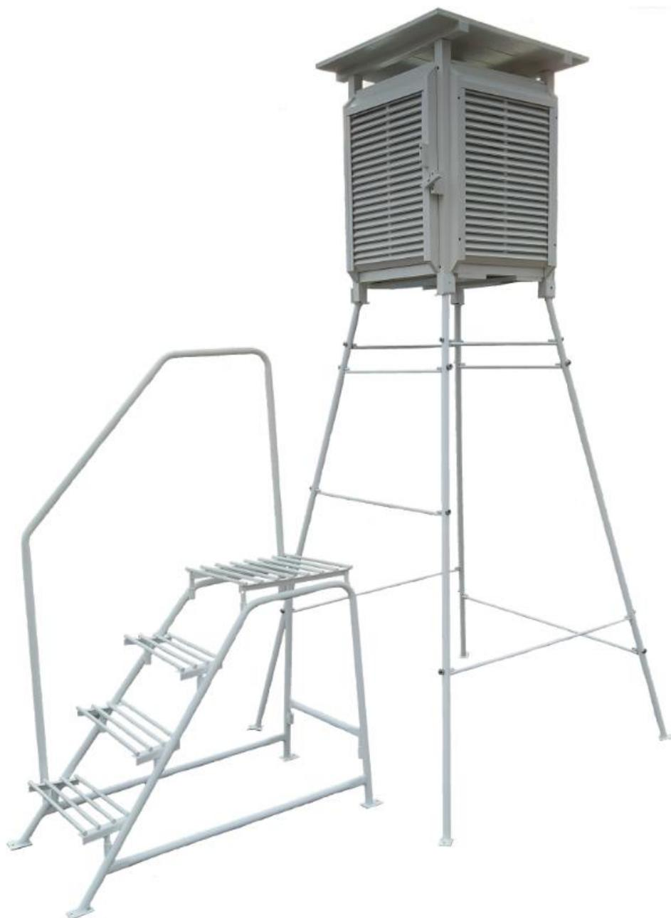
Рисунок 1.2 – Термометрическая будка
