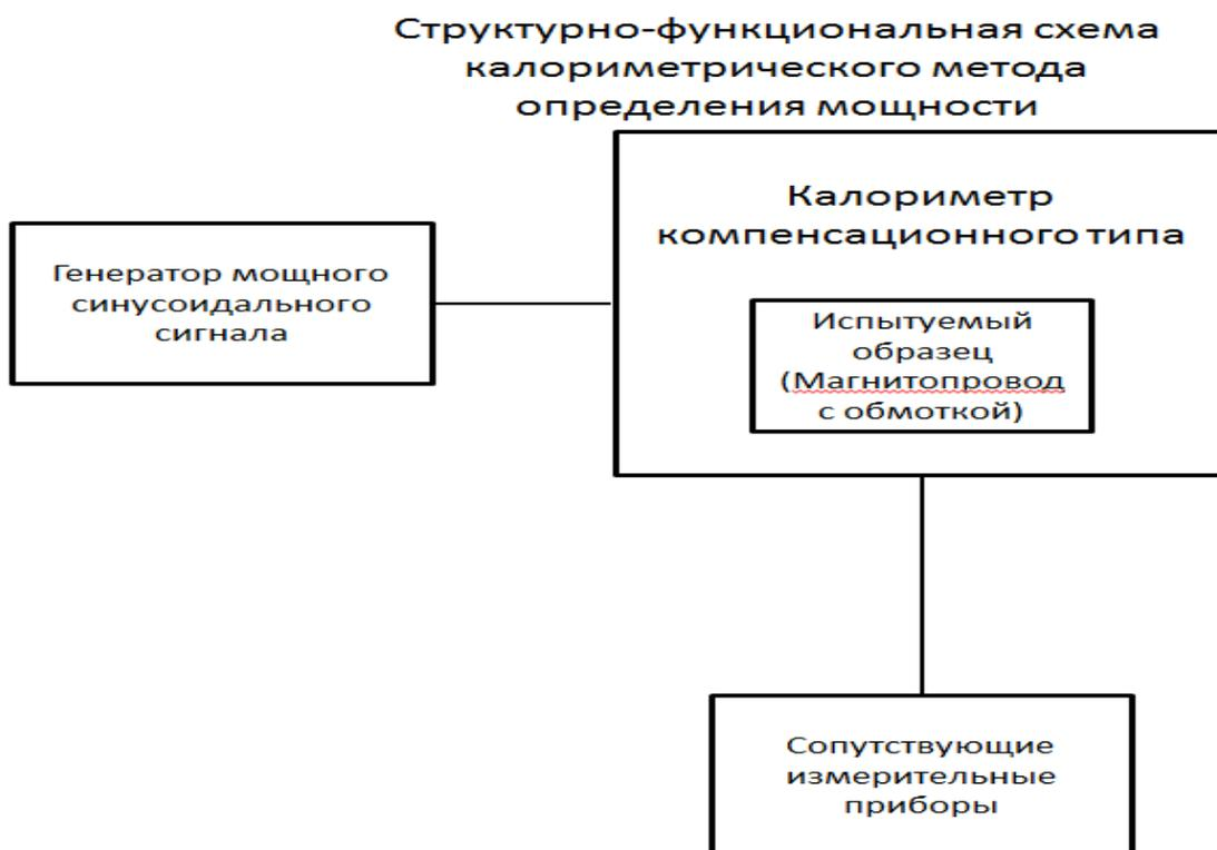
Рисунок 6 – калориметрический способ определения потерь
