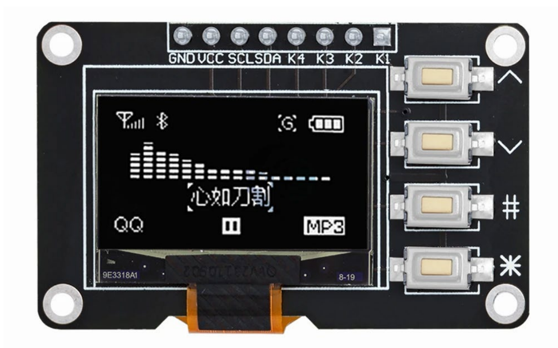
Рисунок 2.4 - OLED-дисплей с кнопками для локального интерфейса комплекса
