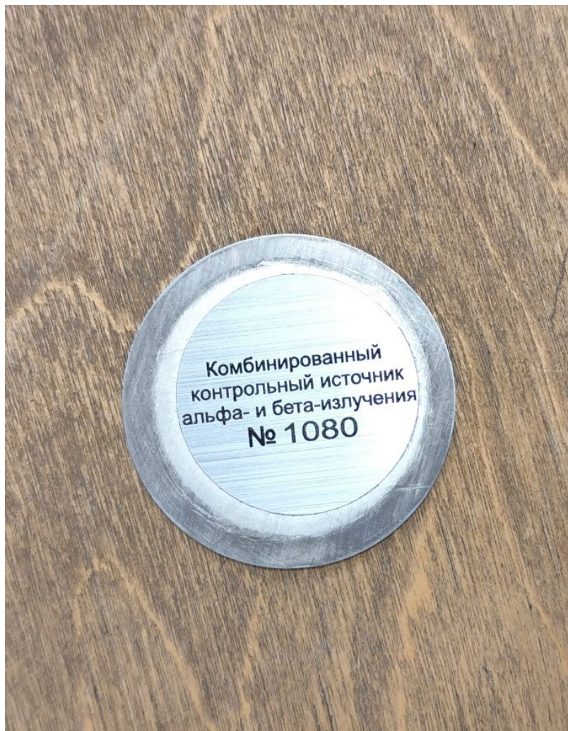
Рисунок 3.8 – Контрольный источник альфа- и бета-излучения №1080
