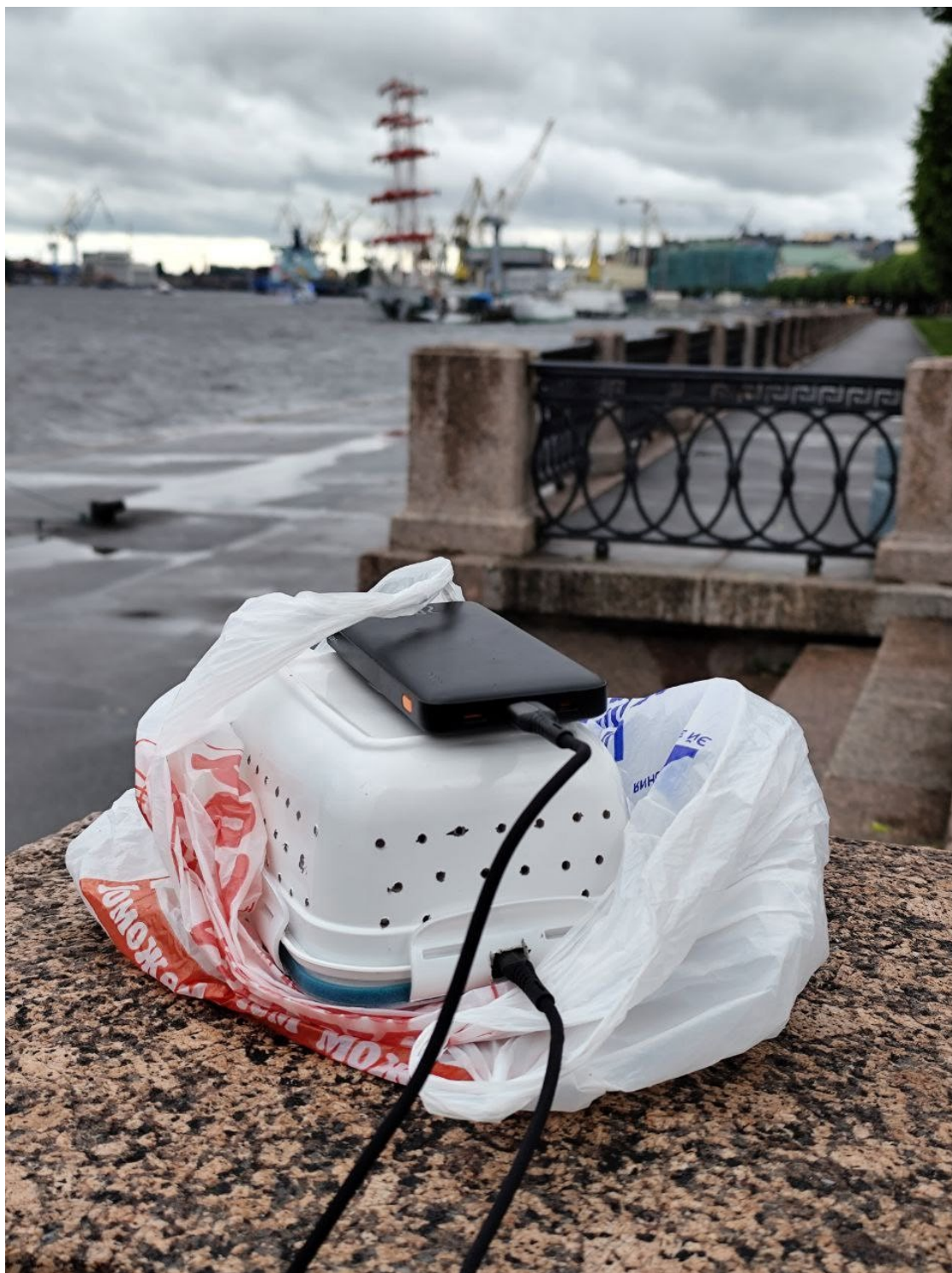
Рисунок 2.8 - Защитный корпус прибора во время полевых измерений
