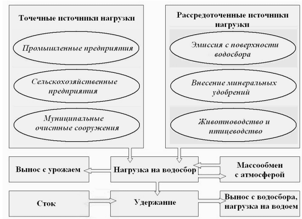
Рисунок 2 - Схема модели выноса химических веществ с водосбора и формирования внешней нагрузки на водоемы
