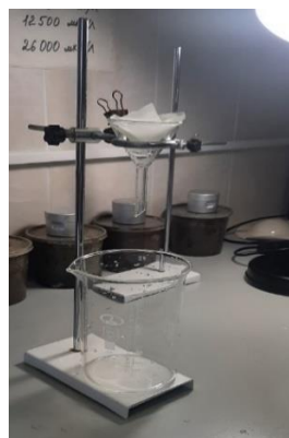
Рисунок 2.4 – Установка для сырого просеивания
