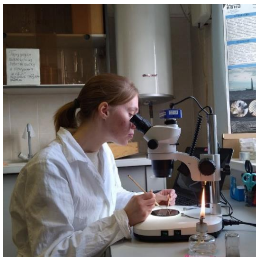
Рисунок 2.5 – Анализ проб методом горячей иглы с использованием микроскопа
