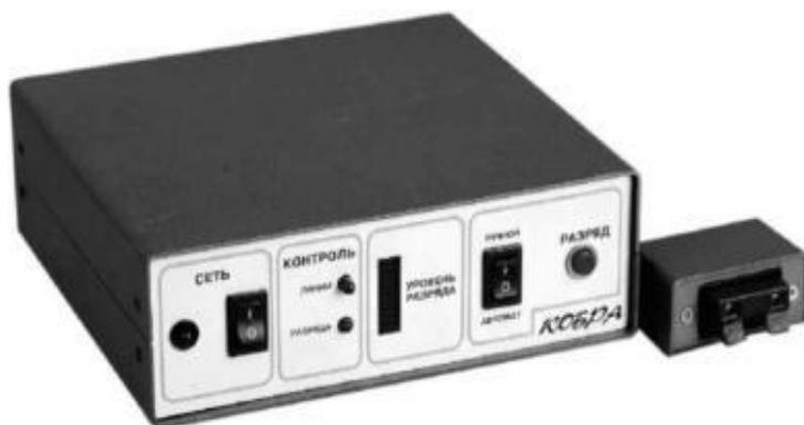
Рисунок 3.8 - выжигатель телефонных закладных устройств «Кобра»
