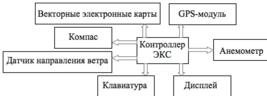
Рис.1 Структурная схема ЭКС.
