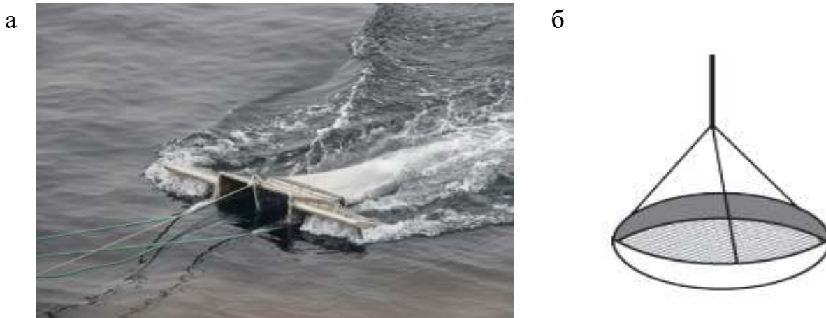
Рисунок 1.5.1 – Процесс отбора проб с помощью нейстонной сети (а), металлическое сито для касания поверхности воды (б)
