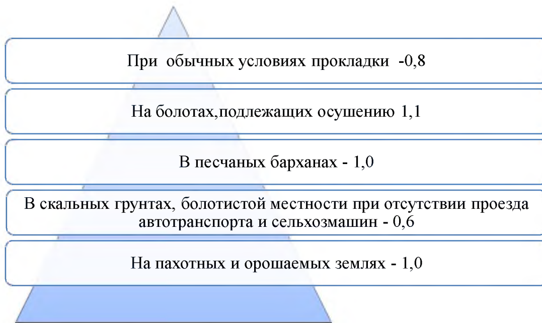
Рисунок 1.12 –Уровень заглубления трубопроводов
