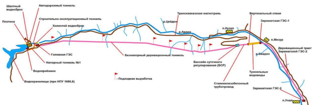
Рисунок 1 - Схема расположения объектов Зарамагского каскада.
