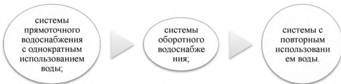
Рисунок 1.7 –Виды схем по способу использования воды:
