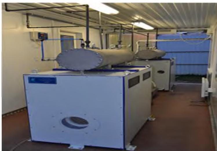
Рисунок 3.5 - Озонатор лабораторный [11, с. 129]
