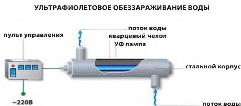
Рисунок 3.4- Метод очистки воды путем УФ - установки [14, с. 81]
