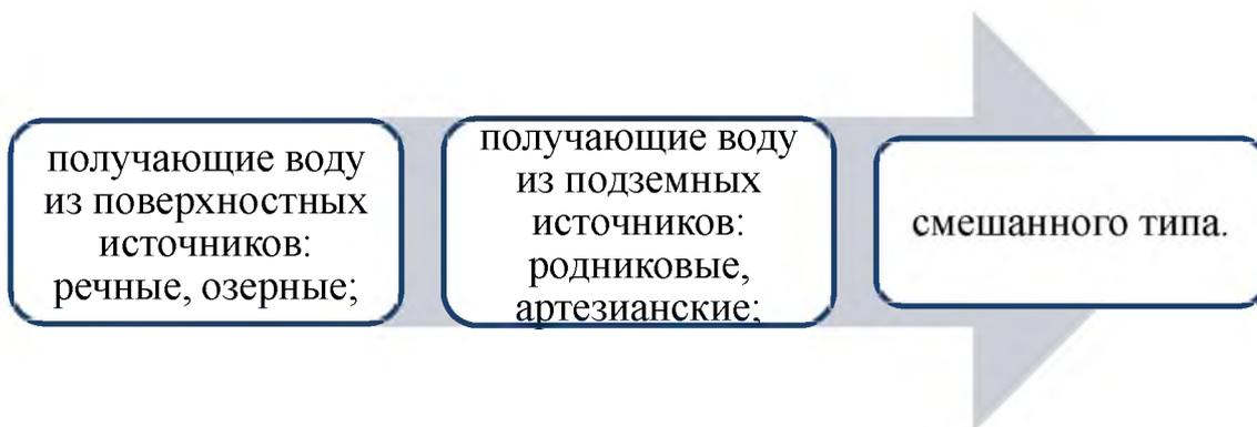
Рисунок 1.6 – Схема подачи в зависимости от источника
