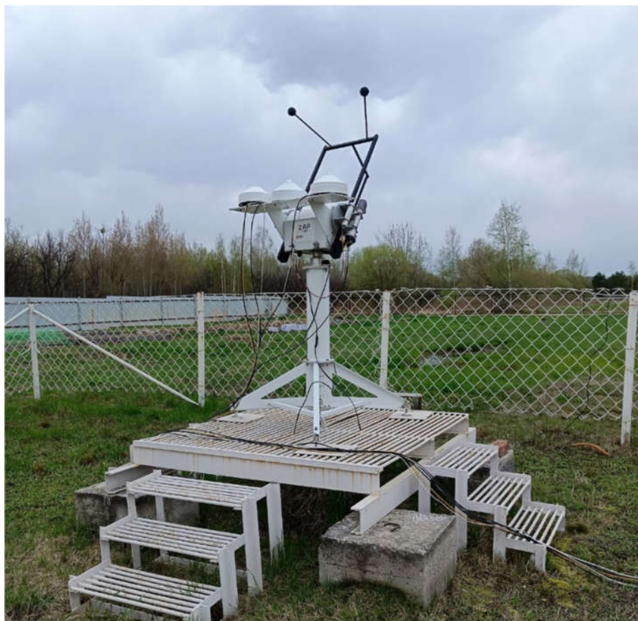
Рисунок 2.1 – Двухосевая станция слежения за Солнцем с установленными на ней, пиргелиометром СНР-1, двумя пиранометрами СМР-6, пиргеометром CGR-4 и двумя затеняющими кольцами СМ 121
