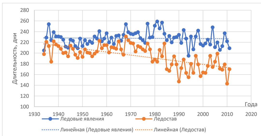
Рисунок Хронологический график колебания ледовых явлений и ледостава, выраженные в днях в году р. Обь – г. Салехард
