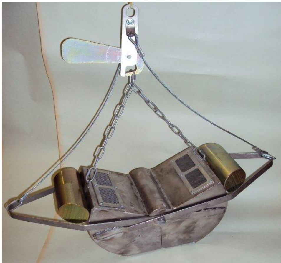
Рисунок 5 – Дночерпатель Петерсена (модифицированная модель)
