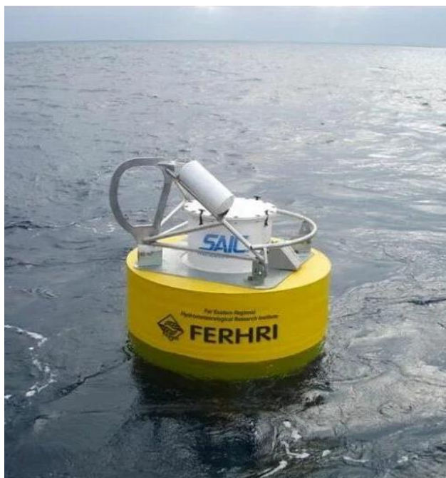
Рисунок 1.7 – Внешний вид буйковой станции предупреждения о цунами
