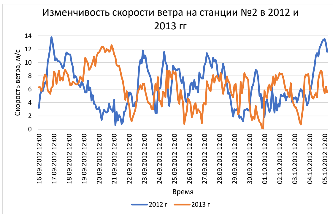
Рисунок 3.12 – Сравнение хода скорости ветра на буйковой станции №2 для 2012 и 2013 гг
