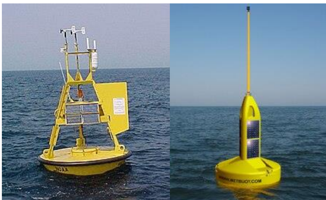
Рисунок 1.1 – Внешний вид буйковой АМС
