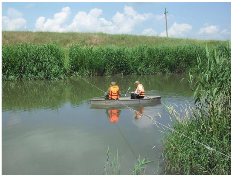
Рисунок 2.2 – Измерение скоростей течения воды, р. Хаболовка.
